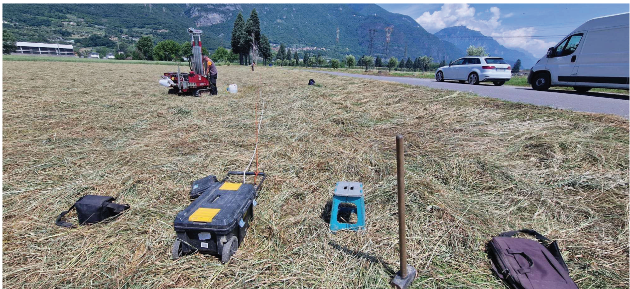
Figura 11. Stendimento MASW eseguito sull'area di studio.
