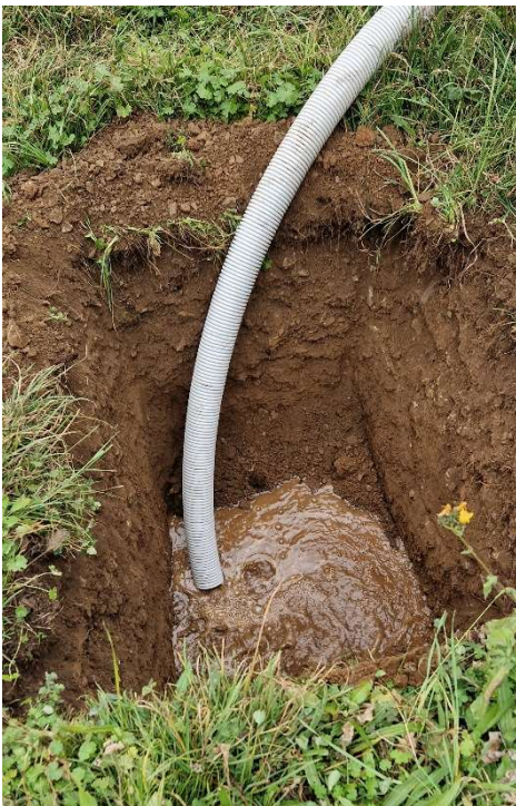
Figura 6. Documentazione fotografica della prova di permeabilità eseguita.
