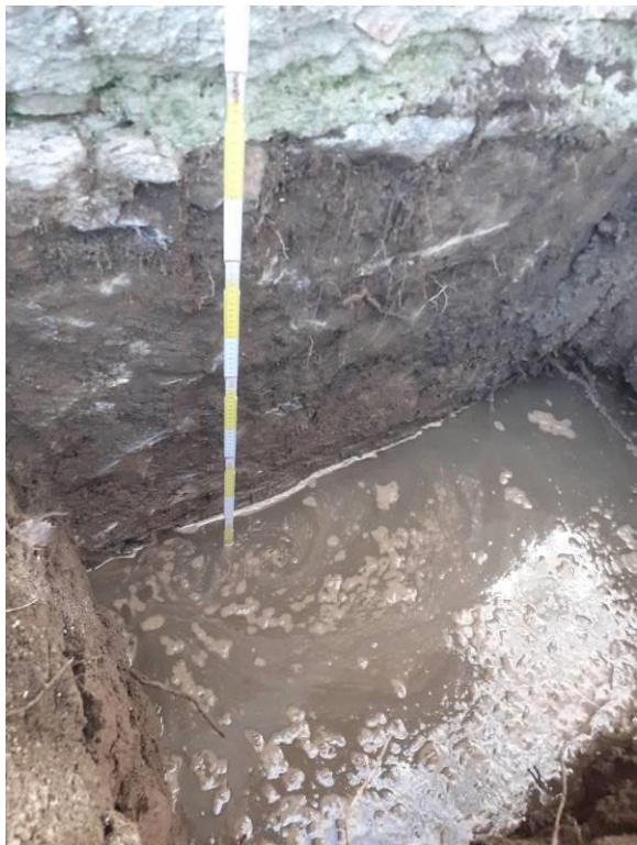
SAGGIO FONDAZIONE LATO NORD (PRESENZA DI ACQUA DI FALDA)
