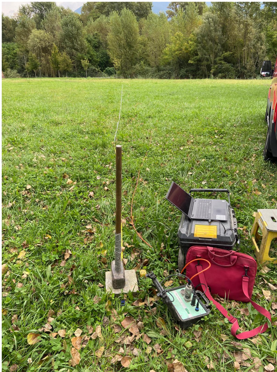
Figura 5.5 - Stendimento sismico MASW
