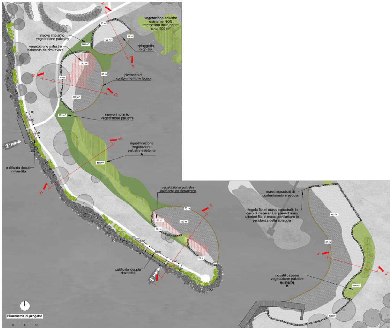
Figura 2.11 – Zoom planimetria di progetto area sud con indicazione sezioni
